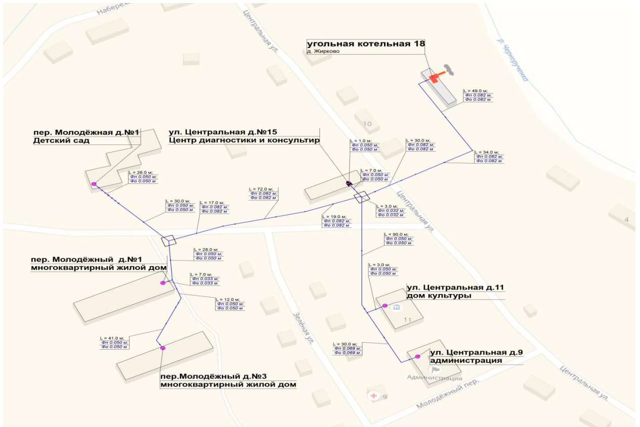
Рисунок 1.1 Схема тепловых сетей котельной № 18, д. Жирково
